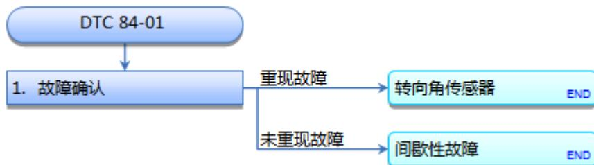
**DTC 84-01: 转向角传感器故障**
